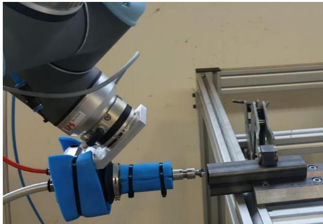
Welser Profile – Testanwendungen Spindelentgraten / Granulat - Entgraten
